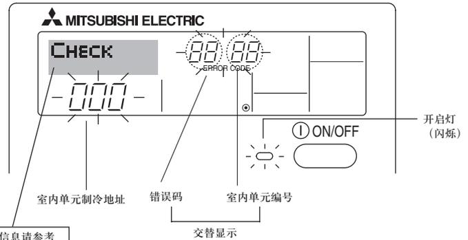
如在故障时已输入需要呼叫的联络编号，屏幕会显示此编号。(可在遥控器的功能选择下设定。有关信息请参考第 8 部分)。
