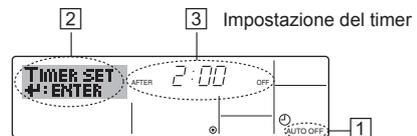
1. Assicurarsi che sia visualizzata la schermata di controllo standard e che l'indicatore corrispondente al timer di arresto automatico ① sia visualizzato sul display.
