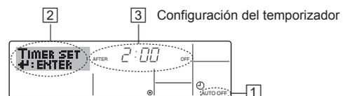
1. Asegúrese de que usted se encuentre en una pantalla de control estándar y que el indicador del temporizador de apagado automático Auto Off se muestre en la pantalla (en ①). Cuando aparezca una indicación distinta de la del temporizador de apagado automático, cámbielo a AUTO OFF TIMER (TEMPORIZADOR DE APAGADO AUTOMÁTICO) utilizando la selección de funciones de la configuración de funciones del temporizador del mando a distancia (véase 8.[4]-3 (3)).
