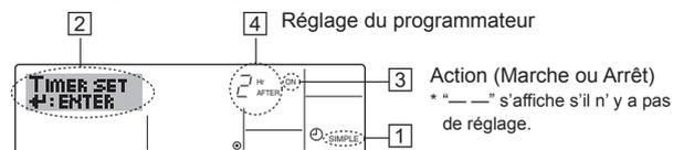
1. Assurez-vous que vous êtes sur un écran de contrôle standard, et que le témoin du programmeur simple s'affiche (en ①). Lorsque qu'une fonction autre que le temporisateur simple est affichée, réglez la télécommande sur SIMPLE TIMER en utilisant le paramètre de fonction temporisateur de la sélection des fonctions (voir 8.[4]-3 (3)).
