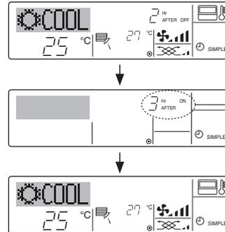
Στην έναρξη χρονοδιακόπτη Η ένδειξη εμφανίζει τη ρύθμιση διακοπής λειτουργίας του χρονοδιακόπτη (ώρες που απομένουν έως τη διακοπή λειτουργίας).
