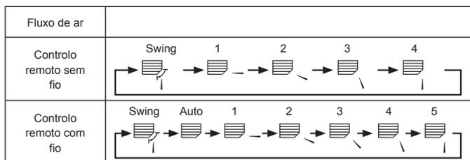
\* Note que durante o movimento da aleta, a indicação da direcção no mostrador não muda relativamente à sincronia com as lâminas na unidade.
