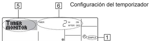
1. Asegúrese de que el indicador del temporizador simple está visible en la pantalla (en ①).
