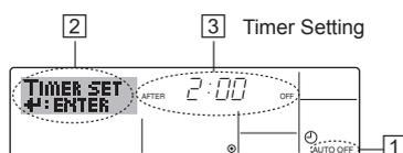
1. Kontroller at man er i displayet til standardstyring og at indikatoren for Auto Off-tidsmåleren er vist i displayet (i ①). Hvis der vises en anden visning end Auto Off-tidsmåler skal den indstilles til AUTO OFF TIMER med funktionsvælgeren (se 8.[4]-3 (3)) for indstilling af tidsfunktionen.
