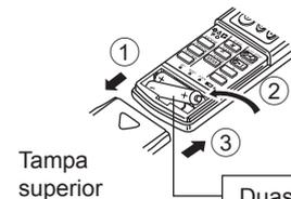
Introduza primeiro o pólo negativo (-) de cada pilha. Coloque as pilhas na direcção correcta (+, -)!
