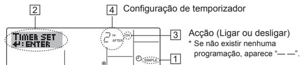
1. Certifique-se de que o mostrador é um mostrador inicial de controlo e que aparece o indicador de temporizador simples (em ①). Quando aparece uma indicação diferente de Simple Timer (Temporizador Simples), active SIMPLE TIMER utilizando a selecção de função (consulte 8.[4]-3 (3)) da programação da função de temporizador.
