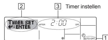
1. Zorg dat u het standaard bedieningsscherm voor u hebt en dat de indicator van de Auto Off-timer (bij 1) op het display wordt weergegeven.
