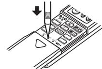
Нажмите кнопку Reset (Сброс) с помощью предмета с узким концом.
