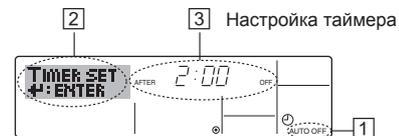
1. Убедитесь, что отображается стандартный экран управления и индикатор таймера отключения (Auto Off) (1).
