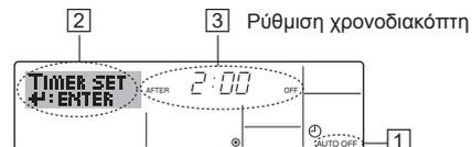
1. Βεβαιωθείτε ότι βρίσκεστε σε τυπική οθόνη ελέγχου και εμφανίζεται ο δείκτης χρονοδιακόπτη αυτόματης διακοπής στην ένδειξη (στο ①). Όταν εμφανίζεται ένδειξη διαφορετική του χρονοδιακόπτη αυτόματης διακοπής, ρυθμίστε την στο AUTO OFF TIMER χρησιμοποιώντας τη ρύθμιση λειτουργίας χρονοδιακόπτη της επιλογής λειτουργίας (βλ. 8.[4]-3 (3)).
