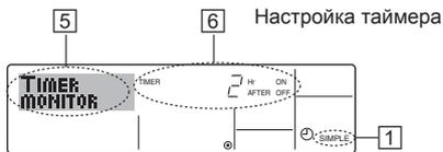
1. Убедитесь, что на экране отображается индикатор простого таймера (1).
