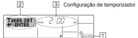
1. Certifique-se de que o mostrador é um mostrador principal de controlo e que a indicação Auto Off (Desligar automático) aparece no mostrador (em ①). Quando aparece uma indicação diferente de Auto Off Timer (Temporizador Desligar automático), active AUTO OFF TIMER utilizando a selecção de função (consulte 8.[4]-3 (3)) da programação da função de temporizador.
