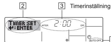
1. Försäkra att du visar standardkontrollskärmen och att indikatorn för automatisk avstängning visas på displayen (vid 1).
