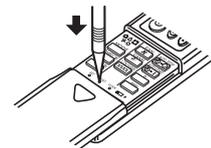
Gebruik een voorwerp met een smalle punt om op reset te drukken.
