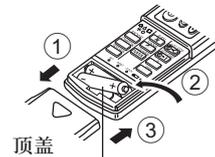
两节 AAA 电池先插入每节电池的负 (-) 极。请以正确方向安装电池 (+, -) !
