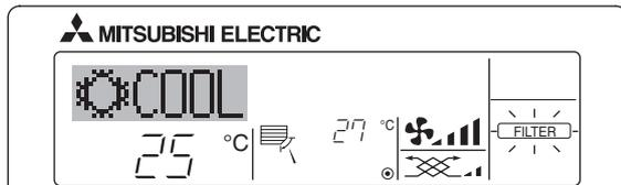
■ Hiermee wordt aangegeven dat het filter moet worden schoongemaakt. Reinig het filter.
