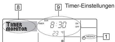
1. Achten Sie darauf, dass die wöchentliche Timer-Anzeige auf dem Bildschirm sichtbar ist (unter 1).
