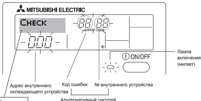
Если вы настроили номер телефона вызова в случае возникновения проблем, этот номер будет отображен на экране. (Вы можете выполнить установку номера телефона на экране выбора функции (Function Selection). За дополнительной информацией обратитесь к разделу 8).
